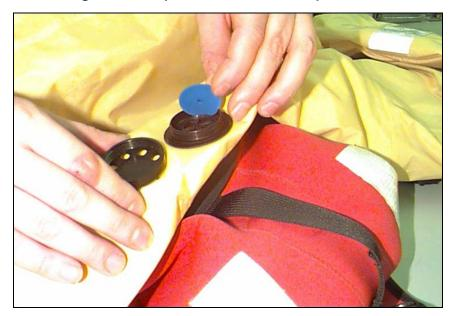
Figure 12. Step a. Exhaust Valve Replacement
